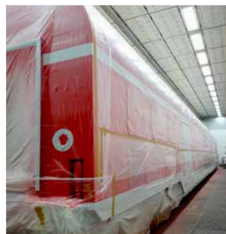
Abgeschliffen und grundiert (Bild links). Nach der roten Lackierung folgt die basaltgraue Lackierung unterhalb der Einstiegstür (Bild rechts).
