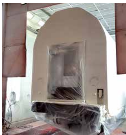
Abgeschliffen und grundiert (Bild links). Nach der roten Lackierung folgt die basaltgraue Lackierung unterhalb der Einstiegstür (Bild rechts).
